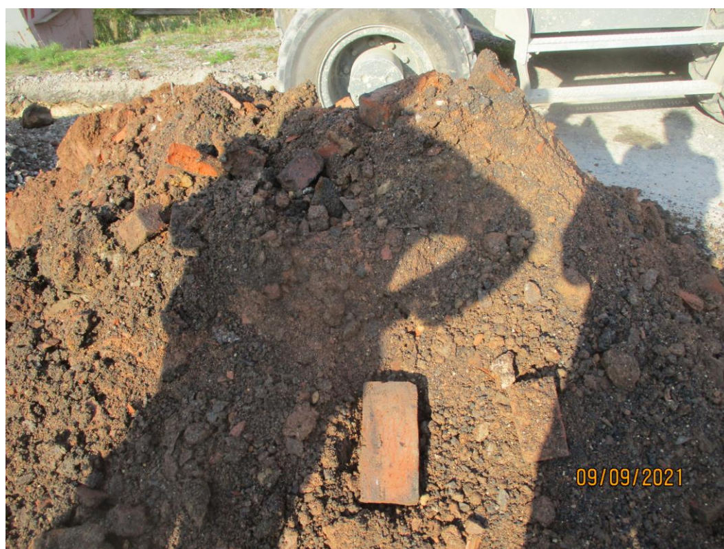
Bild 17: ausgebagerte Auffüllungen, Schurf 1
